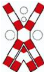
Trecere la nivel cu o cale ferată dublă fără bariere
