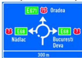
Presemnalizarea direcțiilor într-o intersecție cu sens giratoriu
