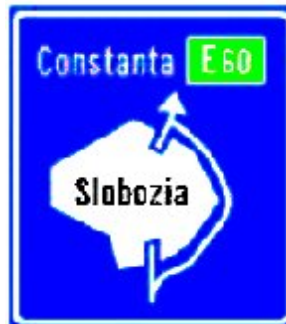
Presemnalizarea traseului de evitare a localității
